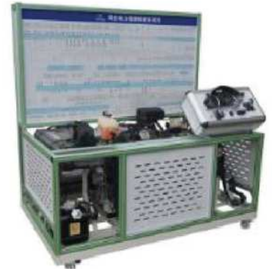
MOTOR DE COMBUSTIÓN INTERNA PARA USO DIDÁCTICO
